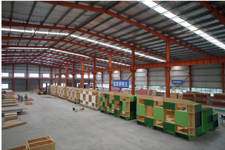
fig.5 工場での「スペース・フレーム型」の組み立てサンプル・テスト [提供：元遠建築科
